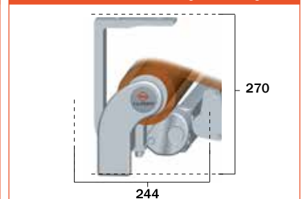
Instalación a techo / Ceiling mounting (mm)
