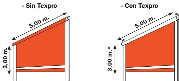
\*Si se utiliza perfil refuerzo, la caída máxima es de 2,30 m.
